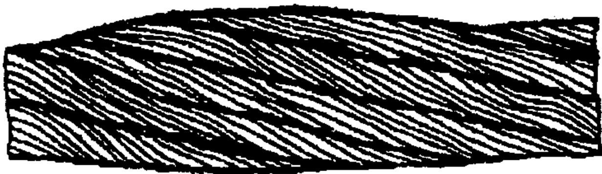
Рисунок 12. Выдавливание проволок прядей
