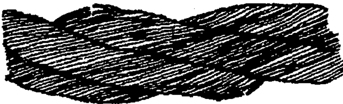
Рисунок 1. Обрывы и смещения проволок каната крестовой свивки
