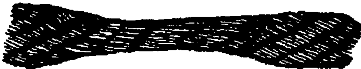
Рисунок 13. Местное увеличение диаметра каната
