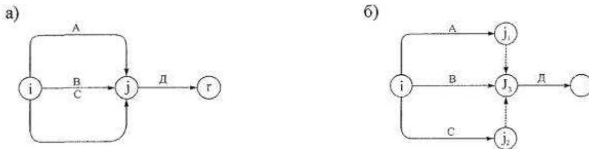
Рисунок 18 - Изображение параллельных работ: а - неправильное; б - правильное.
