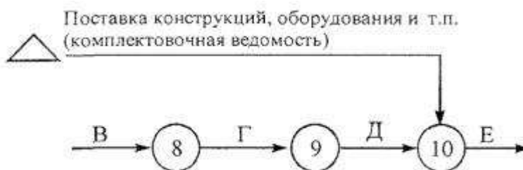
Рисунок 21 - Изображение поставки конструкций, оборудования и т.д.
